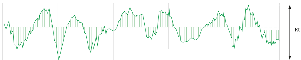
Общая высота профиля микронеровностей ( R_t )
