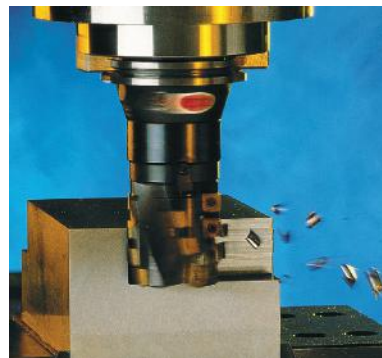
Силовое фрезерование с модульной системой Graflex®: удельный съем металла 432 см³/мин
