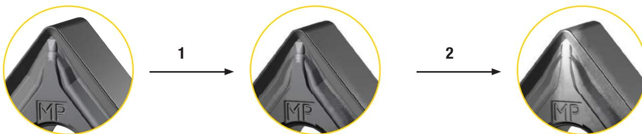
Новое покрытие KCS10B обеспечивает легкое определение износа. Показанный рисунок износа указывает на то, что срок службы инструмента практически подошел к концу.
